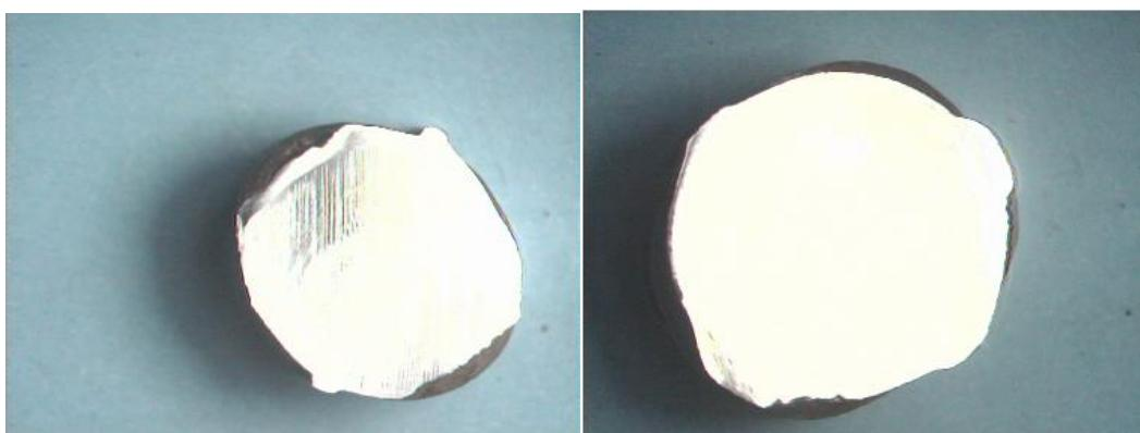
A l'examen macrographique d'une coupe transversale de chaque échantillon, la surface du métal ne doit pas présenter d'irrégularités ou de trace d'attaque profonde due à une corrosion généralisée ou à une éventuelle corrosion localisée sous dépôt.
